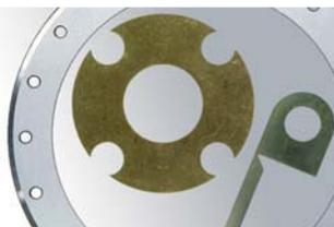
zu bearbeiten. Diese extrem dünnen Passelemente (oder Folien) sind kompakte Passelemente zum Ausgleich von Spielen, die häufig weniger als 1/10 mm betragen. Die nach Zeichnung maßgefertigten Passelemente können aus Stahl Aluminium, Inox oder Polymer (Mylar, Kapton) bestehen. Wir können sie in den Dicken von 0.025, 0.05, 0.10 und 0.20 mm herstellen. Um die hohe Präzision eines Passelements ohne
